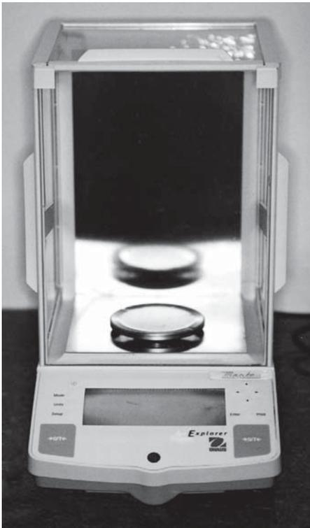
FIGURA 4 - Balança de precisão (Ohaus-Marte).
